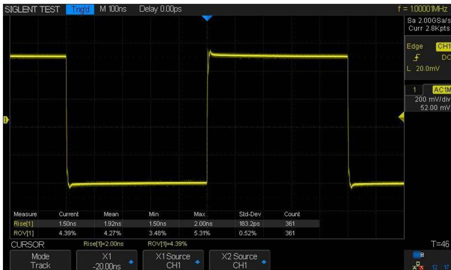
Figura 9 Onda Cuadrada de margen rápido – Usando resorte de tierra.
