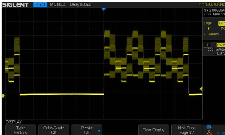
Figura 30 SPO – Intensidad de grado de pantalla (Intensity-Graded Display)
