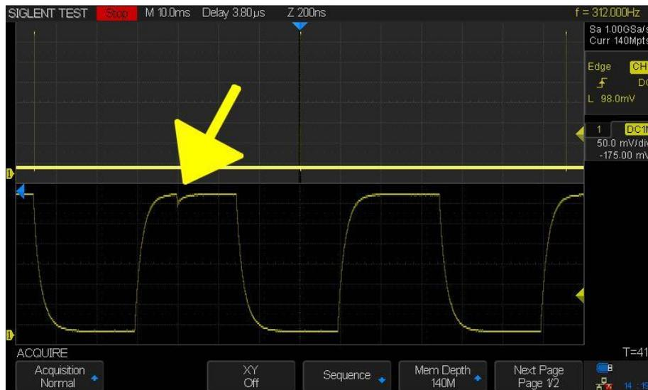
Figura 16 RÁFAGA – Grabación de larga longitud, ampliada para ver el detalle del defecto.
