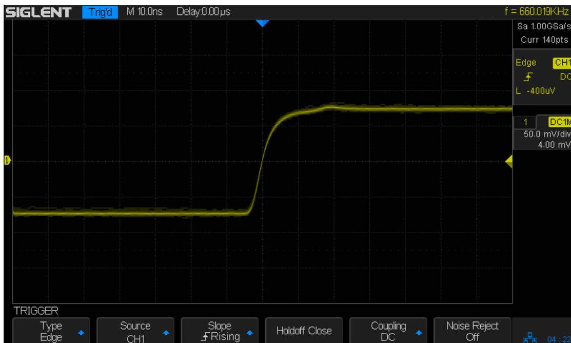
Figure 24: Edge Trigger
