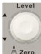
: Ändern des Triggerpegels. Drehen Sie es im Uhrzeigersinn oder gegen den Uhrzeigersinn, um den Pegel zu erhöhen oder zu verringern. Der Triggerpegel bewegt sich nach oben oder unten und der Wert im Anzeigefeld in der unteren linken Ecke des Bildschirms ändert sich mit der Änderung des
