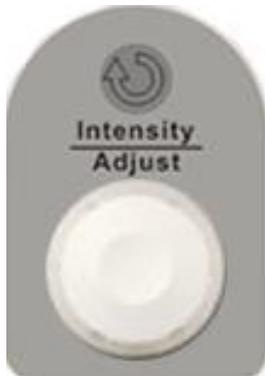
**Anpassen der Kurvenhelligkeit,** Wenn das Licht über dem Knopf nicht leuchtet, wird durch die Benutzung des Knopfes die Kurvenhelligkeit geändert. Es kann zwischen 30%~100% variiert werden. Im Uhrzeigersinn drehen bedeutet erhöhen, während im Gegenuhrzeigersinn verringern bedeutet. Sie können auch "Intensität" im Menü "ANZEIGE" wählen und dann den Regler einstellen, um die Kurvenhelligkeit zu ändern.
