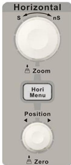
**Hori Menu**: Drücken Sie die Taste, um das horizontale Steuermenü zu öffnen. In diesem können Sie die Delay Sweep-Funktion ein- und ausschalten und die Speichermodi zwischen "Long Save" und "Normal Save" umschalten.
