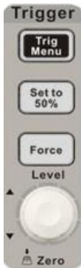
**Trig Menu** : Drücken Sie die Taste, um das Triggermenü zu öffnen, in dem fünf Triggermodi unterstützt werden.
