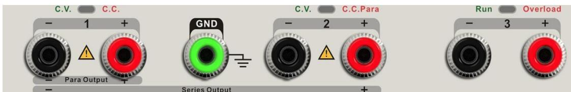
Die Anschlüsse von CH1, CH2 und CH3 beinhalten einen positiven Anschluss und einen negativen Anschluss sowie zusätzlich eine gemeinsame Masse für CH1 und CH2. Jeder Kanal hat sein eigenes Symbol. Die Bediendetails werden in der Folge "Bedienung des Bedienfeldes" vorgestellt.
