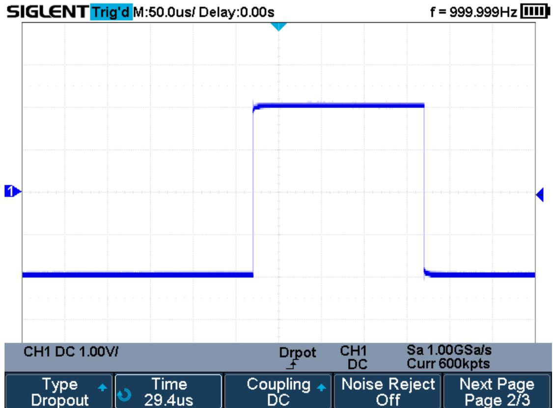
Figure 34 Edge Dropout Trigger
