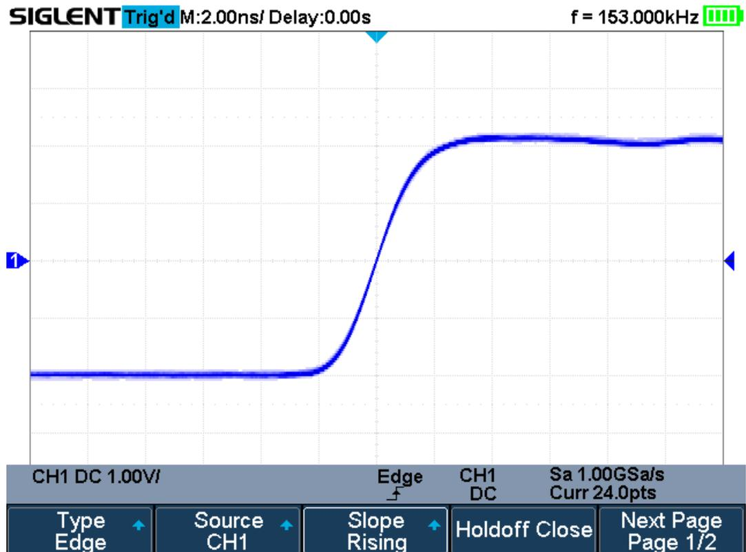
Figure 27 Edge Trigger
