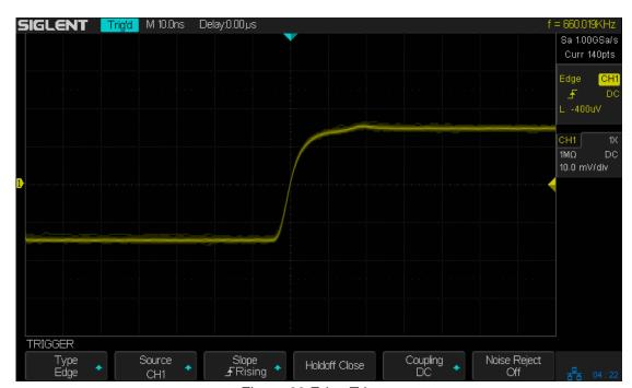
Figure 23 Edge Trigger
